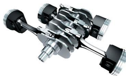
Cilindri opuși orizontal (motor boxer)
