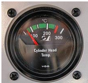
fig.4.42 Indicator al temperaturii chiulaselor cilindrilor (CHT).
