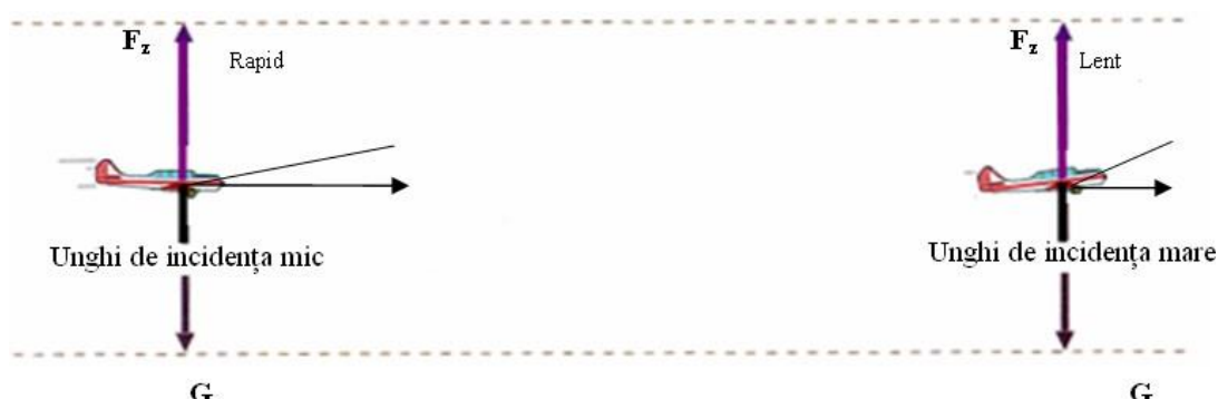
Fig 2.8. Variația unghiului de incidență cu viteza la greutate constantă
