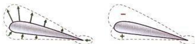
Fig 3.23. Distribuția vitezei și a presiunii statice a curentului de aer
