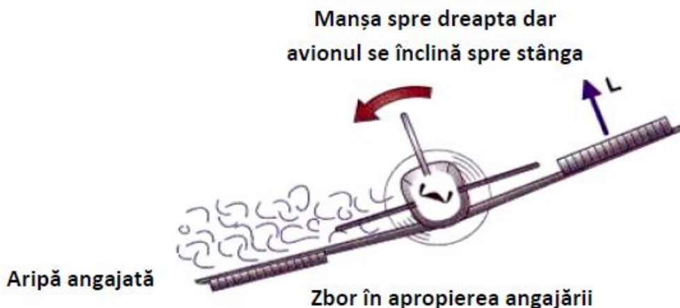
Fig. 13.12 Inducerea vriei prin acționarea inversă a eleronului
