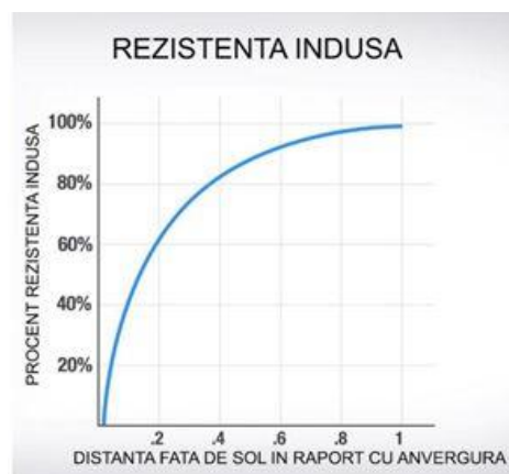
Fig. 2.32 Efectul de sol în funcție de înălțime
